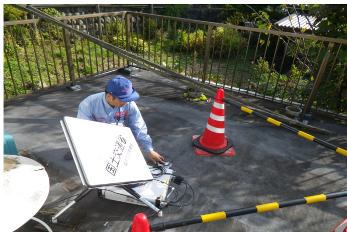
王滝村役場にKu-SAT IIを設置し、リアルタイムで現地映像を配信(9/28より設置)
