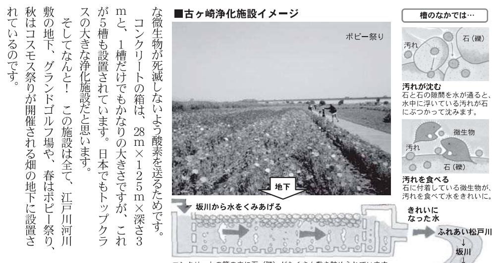
な微生物が死滅しないよう酸素を送るためです。コンクリートの箱は、 $28\text{ m} \times 125\text{ m} \times \text{深さ}3\text{ m}$ と、1槽だけでもかなりの大きさですが、これが5槽も設置されています。日本でもトップクラスの大きな浄化施設だと思います。
