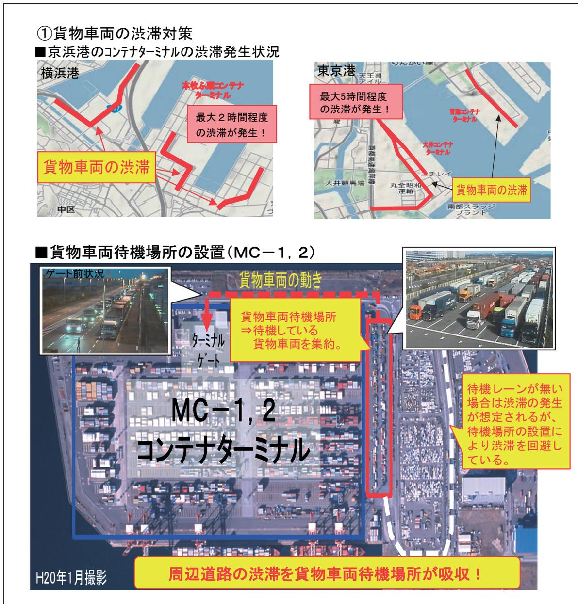
図9 貨物車両待機場所の設置による周辺の渋滞解消
