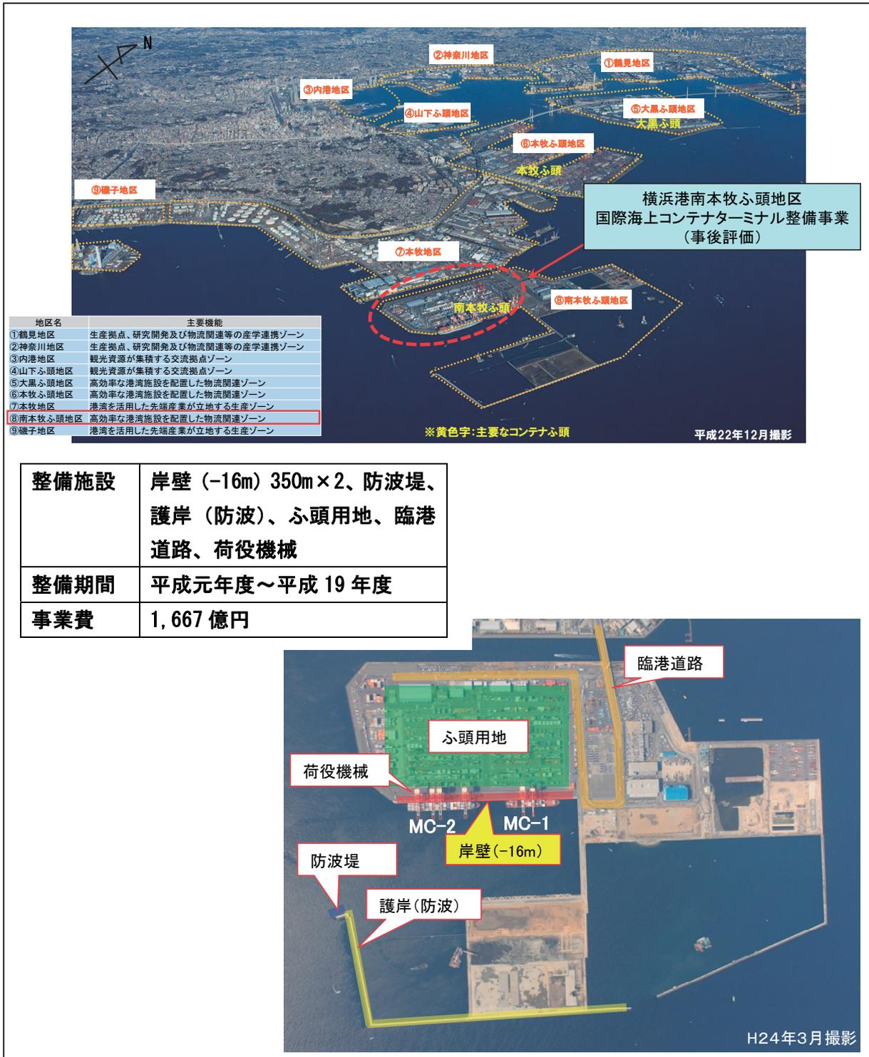
横浜港南本牧ふ頭国際海上コンテナターミナルは、昭和62年の計画決定を経て平成元年に事業着工、平成13年に岸壁(350m×2B)が完成、供用を開始したのち、平成19年度に護岸(防波)の上部工等が完了し、プロジェクトが完了した。
