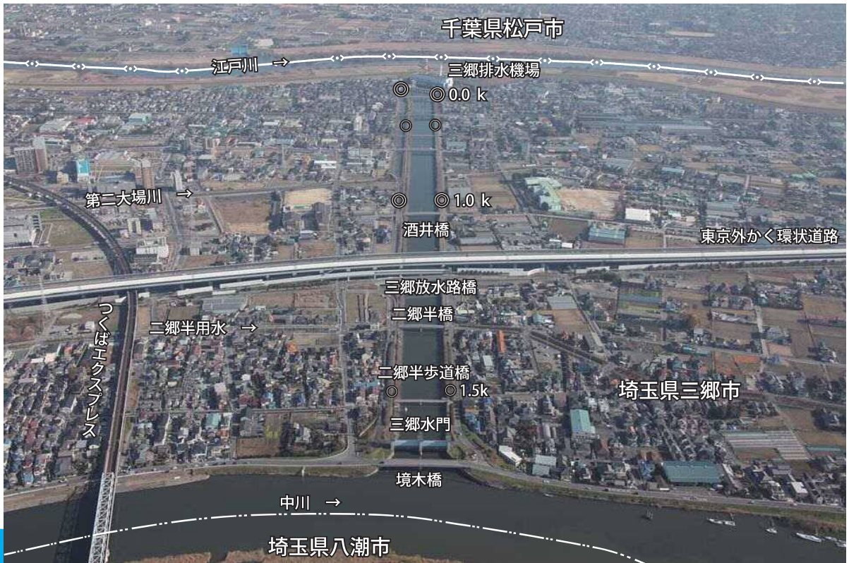
▲三郷水門・・・鋼製ローラーゲート 純径間 22.0m × 扉体高 7.38m × 2門 昭和 49 年完成
