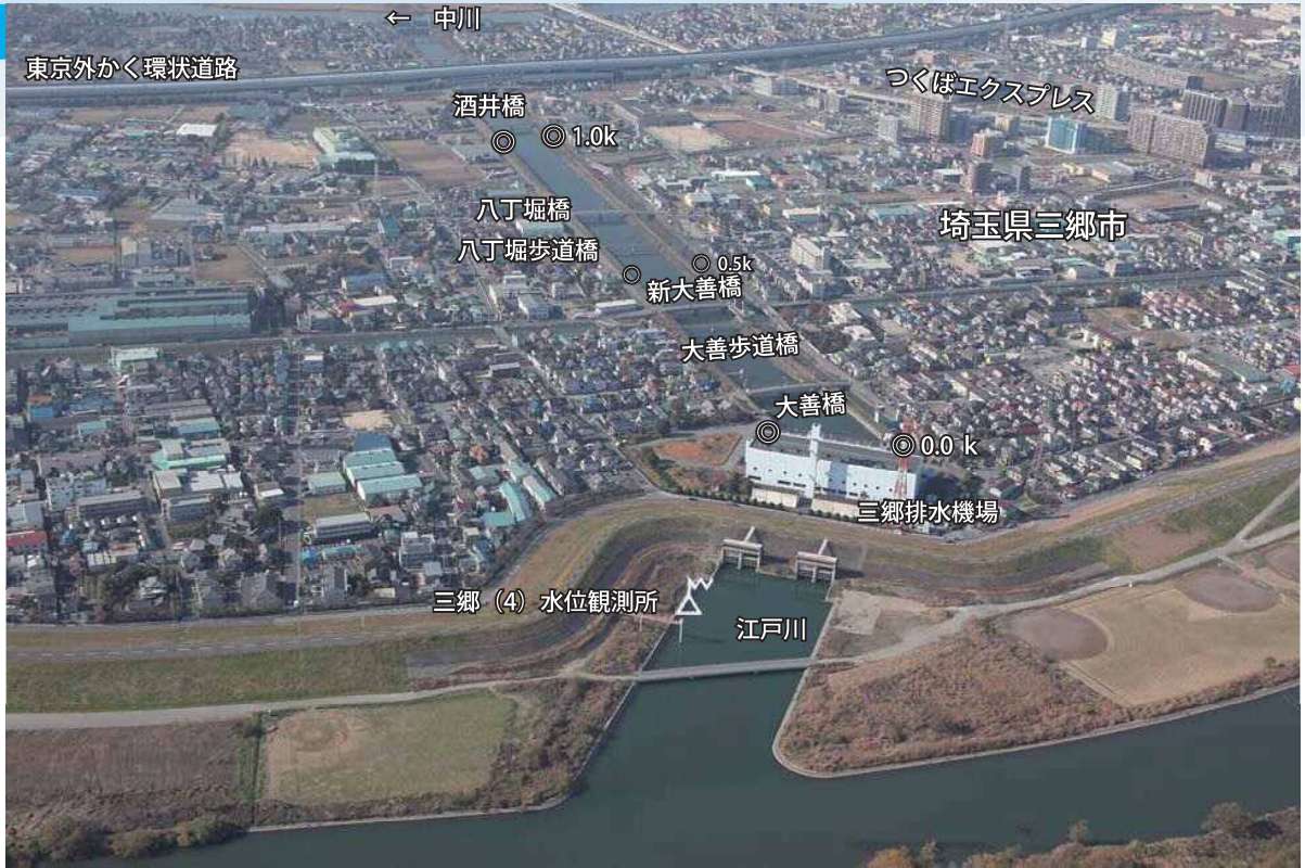
▲三郷排水機場・・・排水量 200m 3 /s (50m 3 /s × 3台 + 20m 3 /s + 30m 3 /s)
