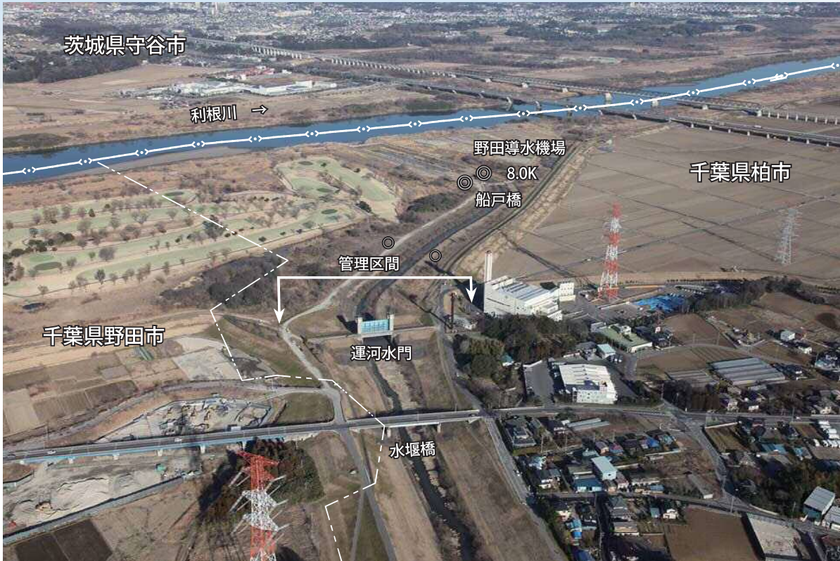
▲運河水門・・・ローラーゲート 純径間 26.0m × 扉高 10.8m 昭和 51 年完成 野田導水機場・・・ポンプ：2m 3 /s × 2 台 昭和 51 年完成
