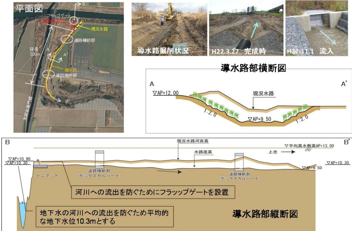
図 4-2 上池呑み口平面図、水路の縦横断面図
