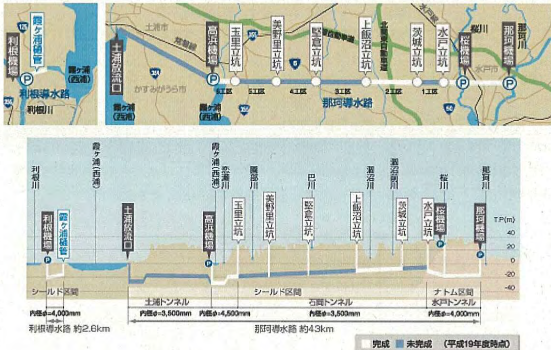
図27 霞ヶ浦導水進捗状況位置図 (出典: 関東地方整備局HP)
