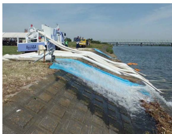
平成25年6月1日 排水ポンプ車出動 (墨田区・向島・本所消防署合同水防訓練)
