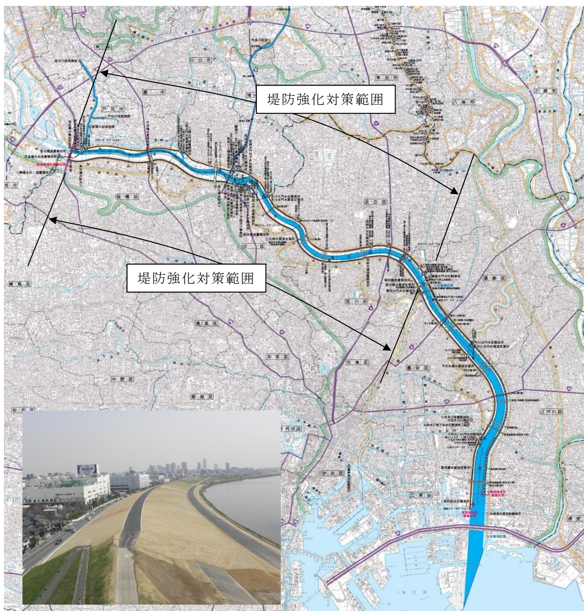
図- 11 堤防浸透対策実施状況概略図
