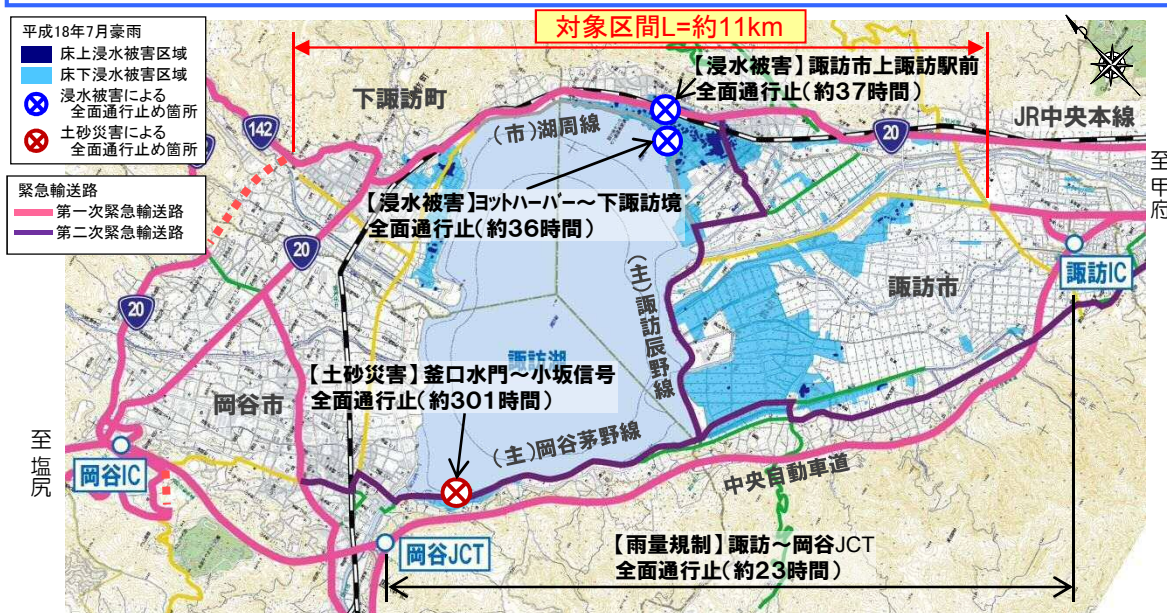
一般国道20号と並行する緊急輸送路の全面通行止め箇所(平成18年7月豪雨)
