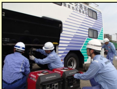
車両のエンジンを止めても発電機により車内へ電力(照明・空調等)を供給できます
