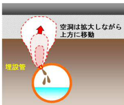
a) 埋設管の老朽化に伴う損傷
