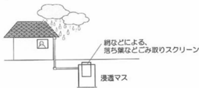
この雨水浸透マスは水を通すマスの周囲に碎石を詰め込んだものです。
