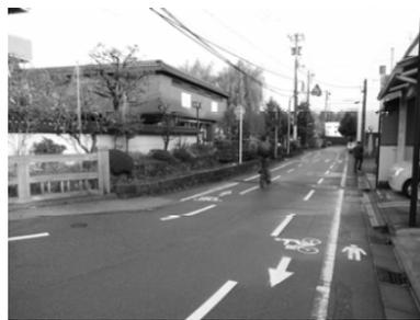
写真Ⅱ- 11 自転車、歩行者双方の通行空間を路面表示により明確化した事例
