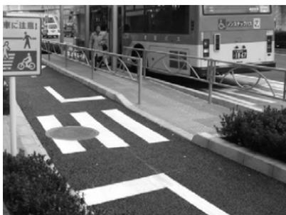
写真Ⅱ-4 停止線を設置した事例
