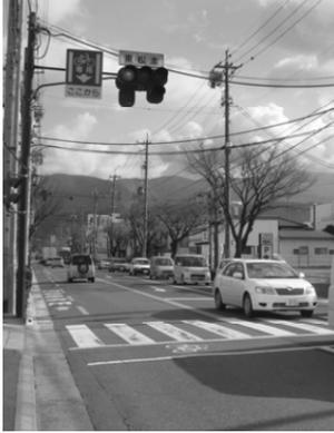
写真Ⅱ- 5 道路標識「専用通行帯（327 の4）」と道路標示「専用通行帯（109 の6）」を設置した事例
