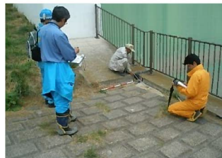
護岸陥没の測定状況
