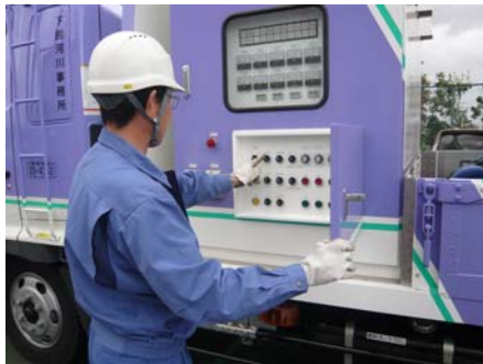
災害用対策機械の点検（排水ポンプ車）
