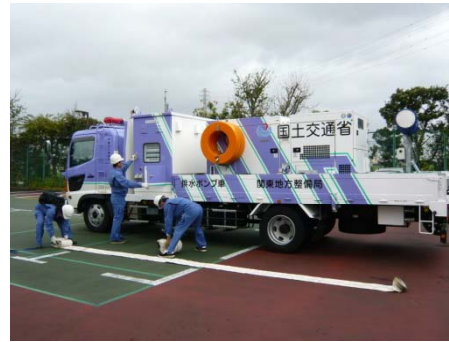
災害用対策機械の点検（排水ポンプ車）
