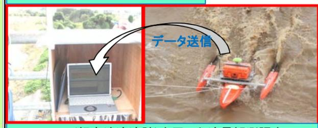
ADCP(超音波流速計)を用いた流量観測調査
