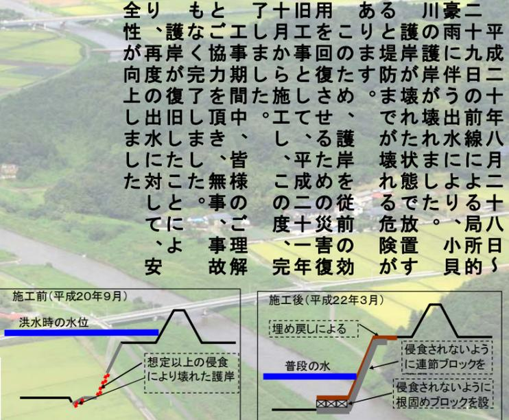
旧工事で壊れた護岸の災害復旧工事が完了しました。
