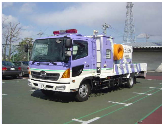
排水ポンプ車:30m 3 /min(水中モータ式)
