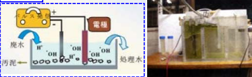
出典：電気化学的高速廃水処理装置の開発 財団法人 茨城県科学技術振興財団 霞ヶ浦水質浄化プロジェクト http://www.i-step.org/kasumi/project/joint_research/introduction/002.htm
