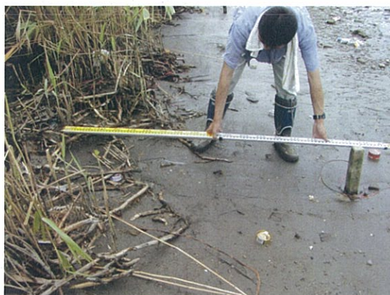
写真 4. 3. 1 ヨシ原侵食状況の計測風景
