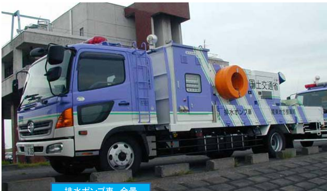
排水ポンプ車 全景
