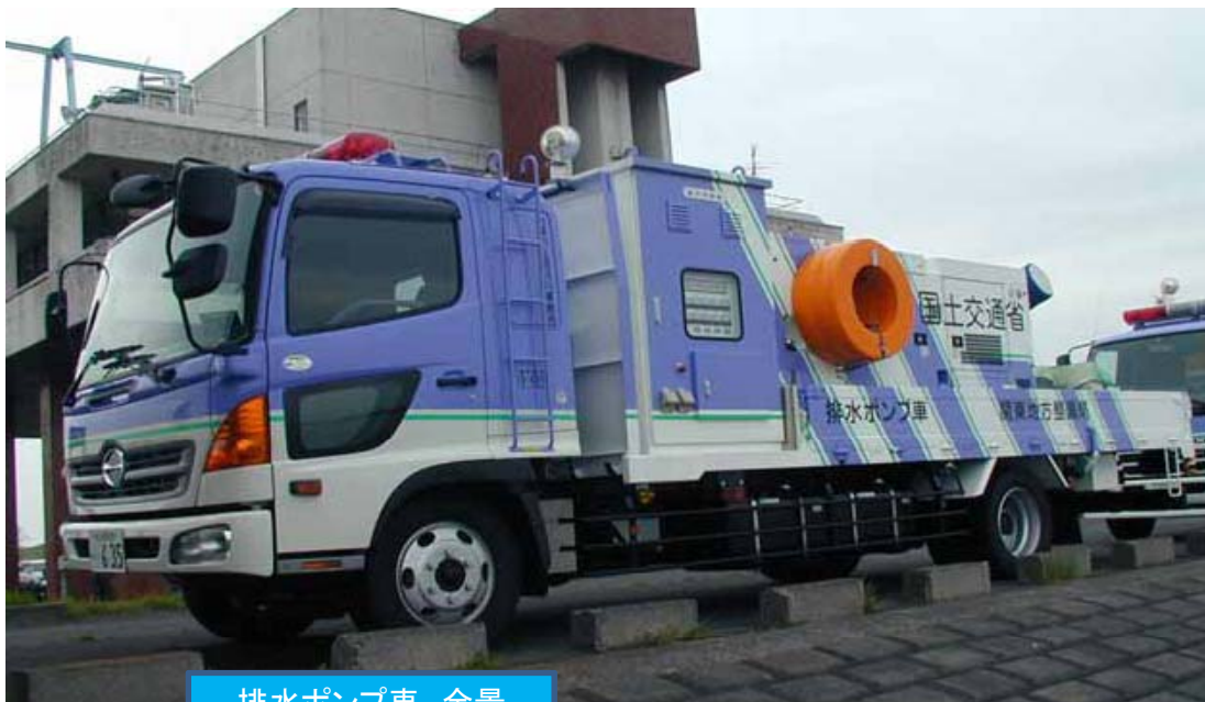
排水ポンプ車 全景
