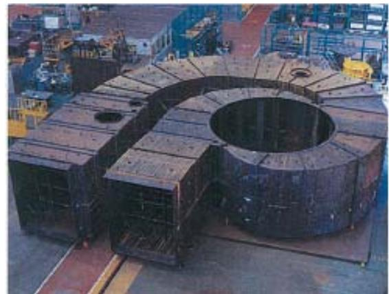
写真-4 ダブルボリュートのポンプケーシングの例
