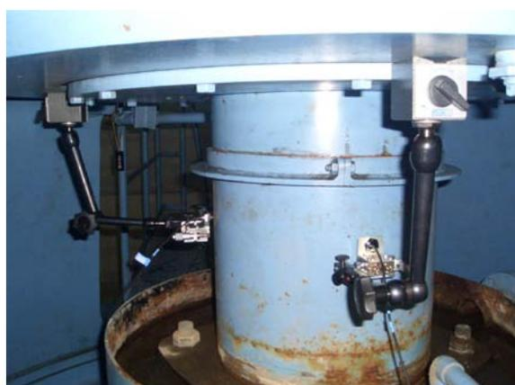
写真-2 渦電流式変位計(設置角90°)
