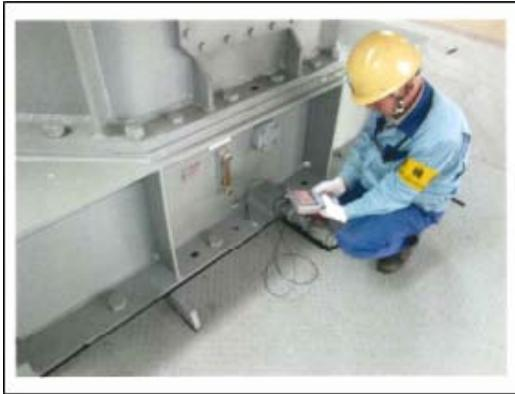
写真-1 振動加速度計による計測方法
