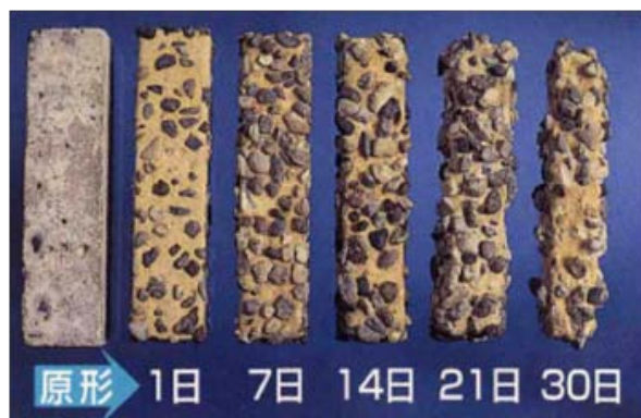
中和前の吾妻川の水につけたコンクリートの状態
