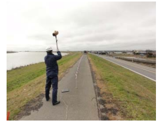
利根川下流堤防上でのランドストリーマー表面波探査風景
