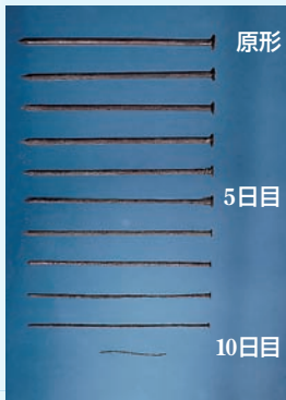
① 図A 湯川の水につけた鉄釘
