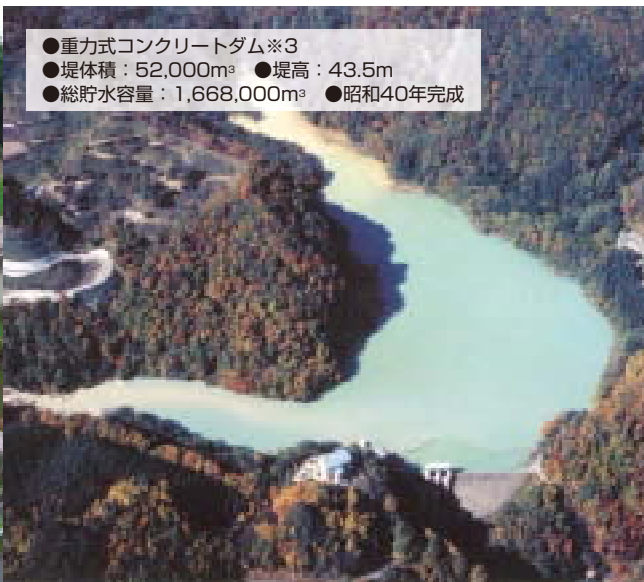
中和生成物を沈澱・収容するために建設された品木ダム
