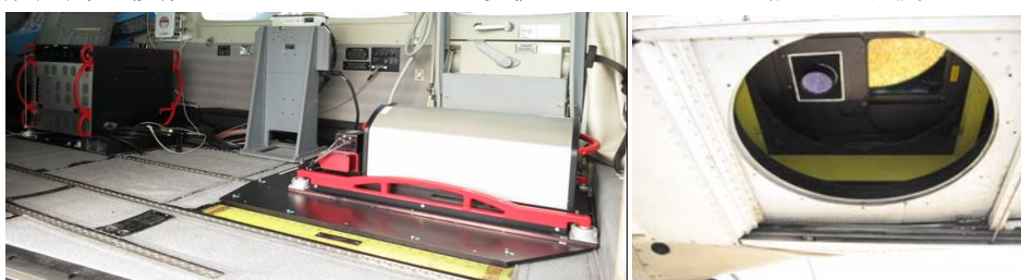
図3 航空レーザ機材の搭載状況(左)と機体下からの様子
