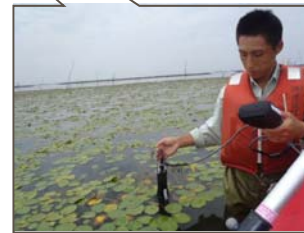
概略水質調査 濁度、透視度、SS、COD、T- N、T-P等の計測
