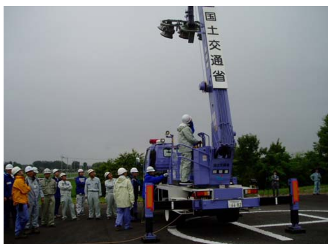
夜間の災害復旧支援としての「照明車」
