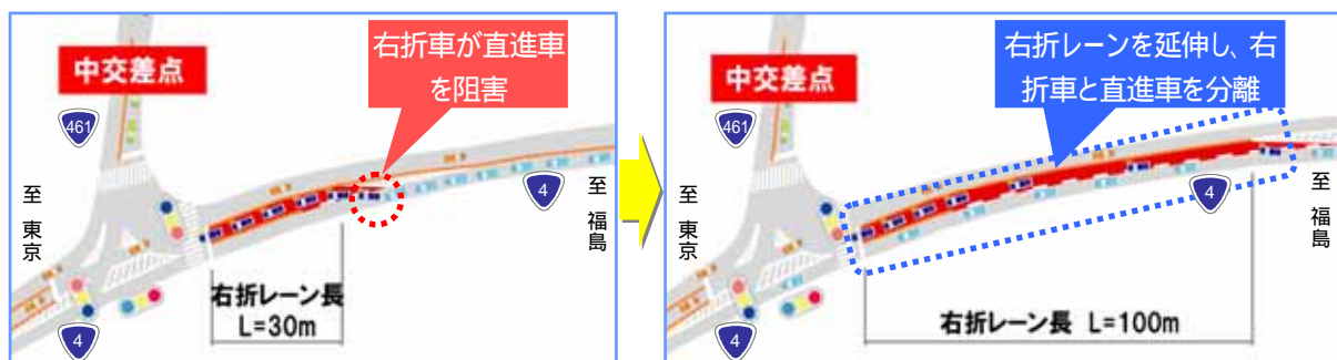
図3 中交差点の渋滞対策(右折レーン延伸)の概要図
