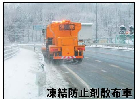
凍結防止剤を散布し、路面の凍結を防ぎ、安全な車道を確認する目的で、使用する車両です。
