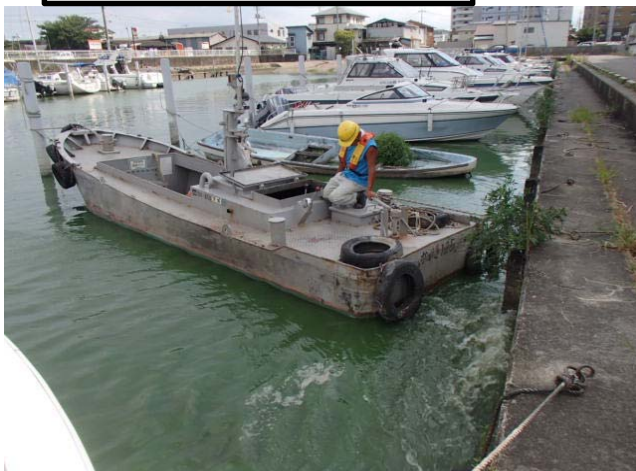
作業船によるアオコ攪拌作業①
