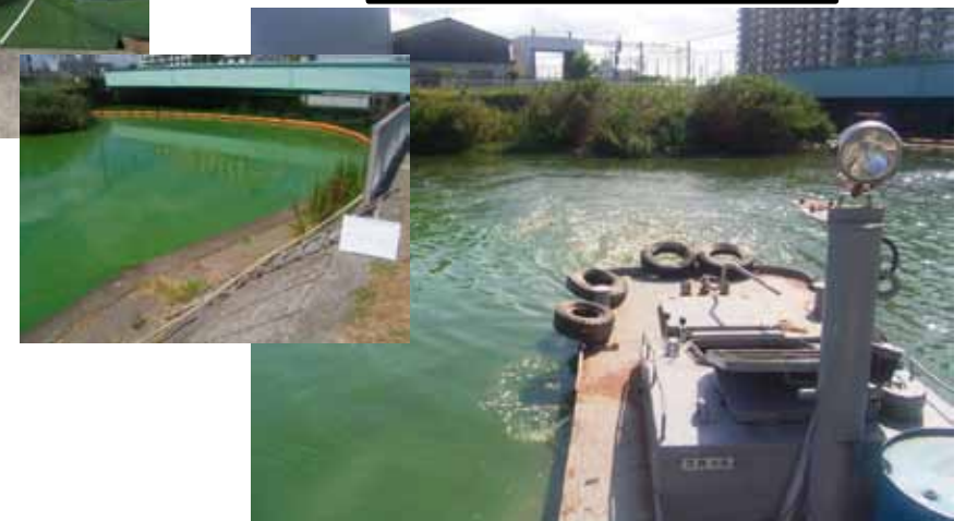
作業船によるアオコ攪拌作業
