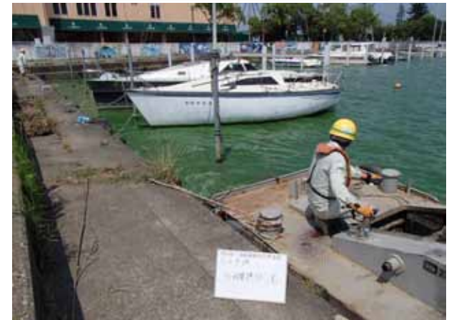
作業船によるアオコ攪拌作業
