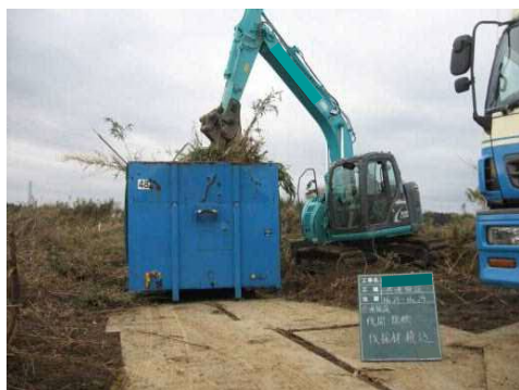
バックホウ(0.25m 3 ) 伐開用リッパ装着
