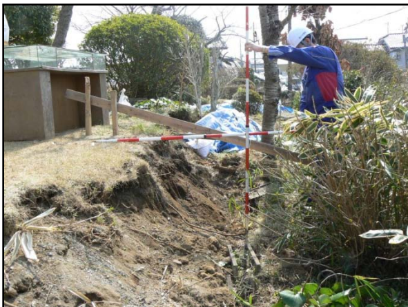
緊急点検～陥没により生じた斜面上部の段差～
