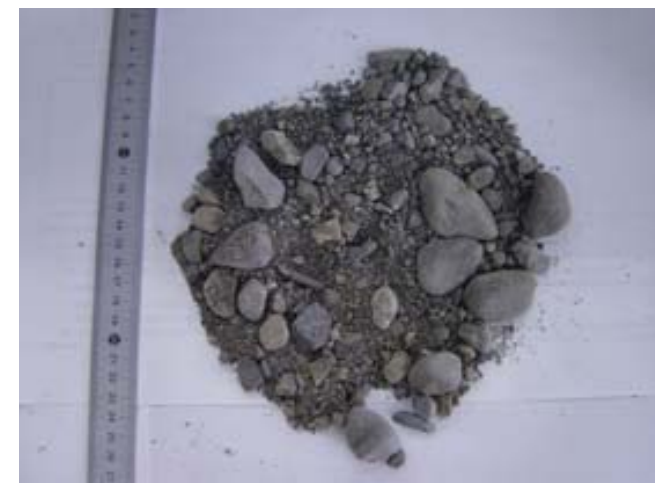
礫分主体の浚渫土砂
