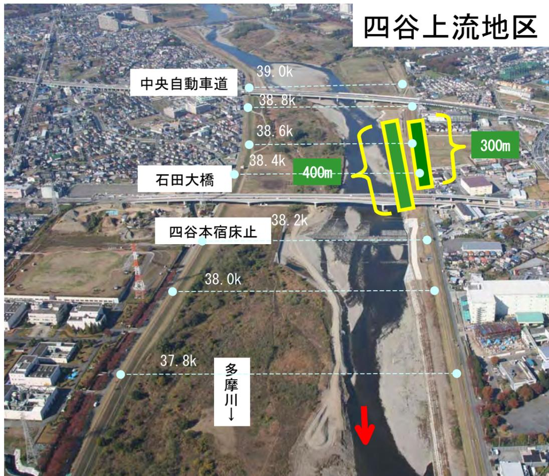
この区間では、川の流れによって堤防が削られるのを防ぐために必要な河川敷の幅を確保するとともに、堤防と河岸の強化を図るために『低水護岸工事』と『高水護岸工事』を実施しました。
