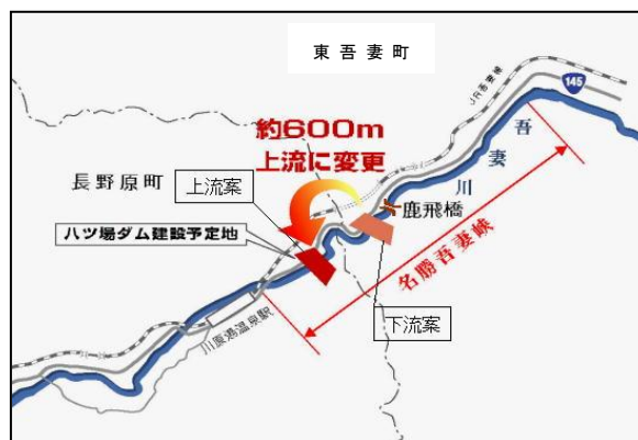
図 3-2-1 ダムサイト位置の変更状況
