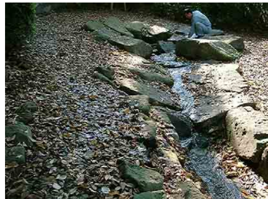
図 3 浮きを流した流量測定
