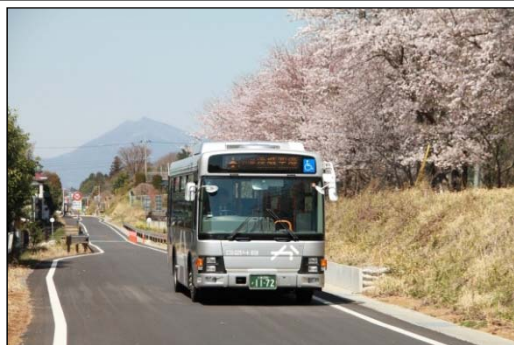
写真 バス専用道路(廃線敷き)を走行するBRT
