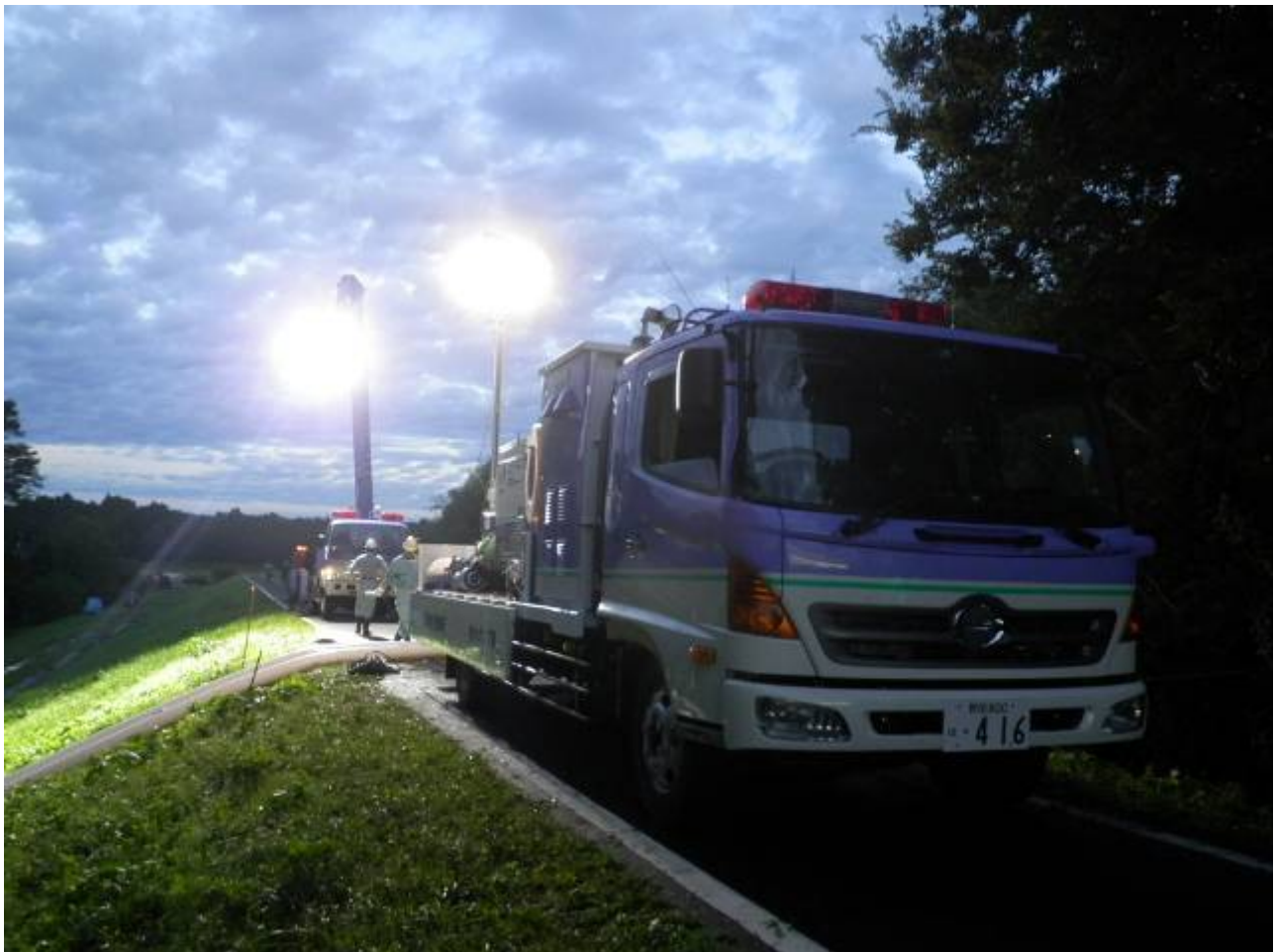
排水ポンプ車及び照明車
