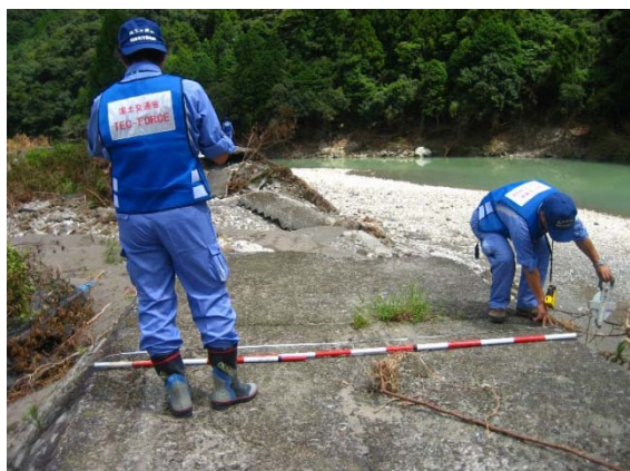
堤防の被災調査【古座川】 (古座川町立会地先)
