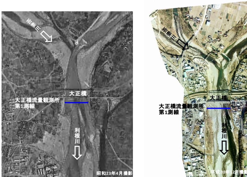
図3 昭和23年4月空中写真と平成20年12月空中写真による河川幅の比較
