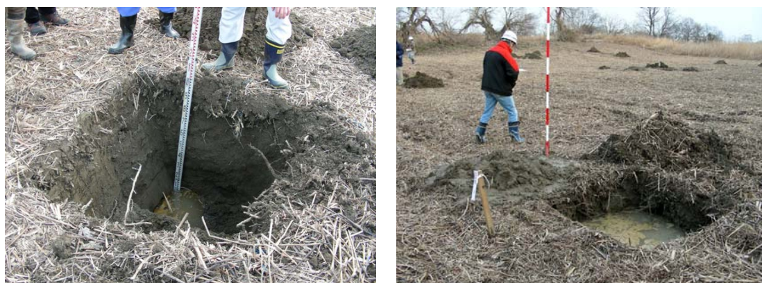
図2-15 上池における試験掘削状況 (H21.02)
