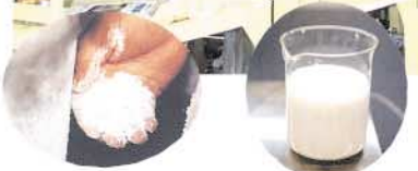
石灰の大きさは、75μm。湯川の水に溶けやすい粒の大きさなんだ くみ上げた水と石灰を混ぜた石灰水を湯川に流している
