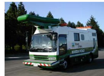
写真：路面性状計測車両
