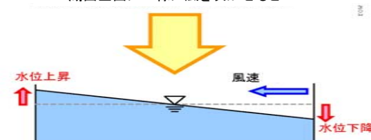
図. 水位上昇(吹き寄せ)の概念図
